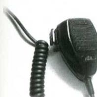
**HEIL HMM KÄSIMIKROFONISSA on HC-4 ja HC-5 mikrofonikapselit valittavissa kytkimellä.**
